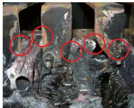
焼損MCCB 電源側拡大
