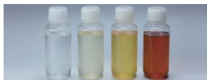
新油から劣化油への色相診断図
