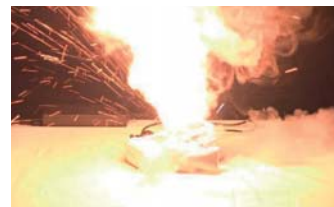
リチウムポリマー電池を他機器の充電器で充電し出火 (出典:東京消防庁)
